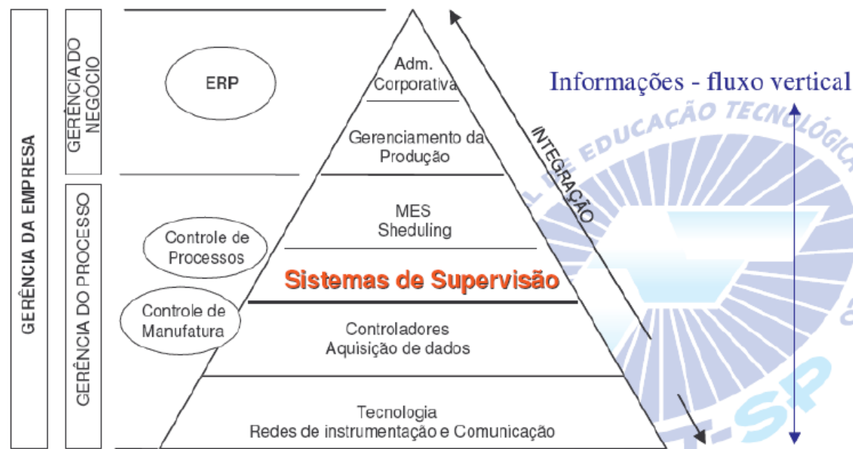
Figura 2. Função das camadas de uma hierarquia de automação.
